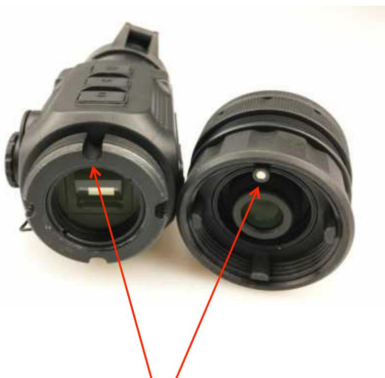
**Bei der Adaption der Kollimatorlinse ist darauf zu achten, dass der runde metallische Zapfen in die runde Nut des Gewindes geführt wird. Nur in dieser Position lässt sich die Linse anschrauben!**
